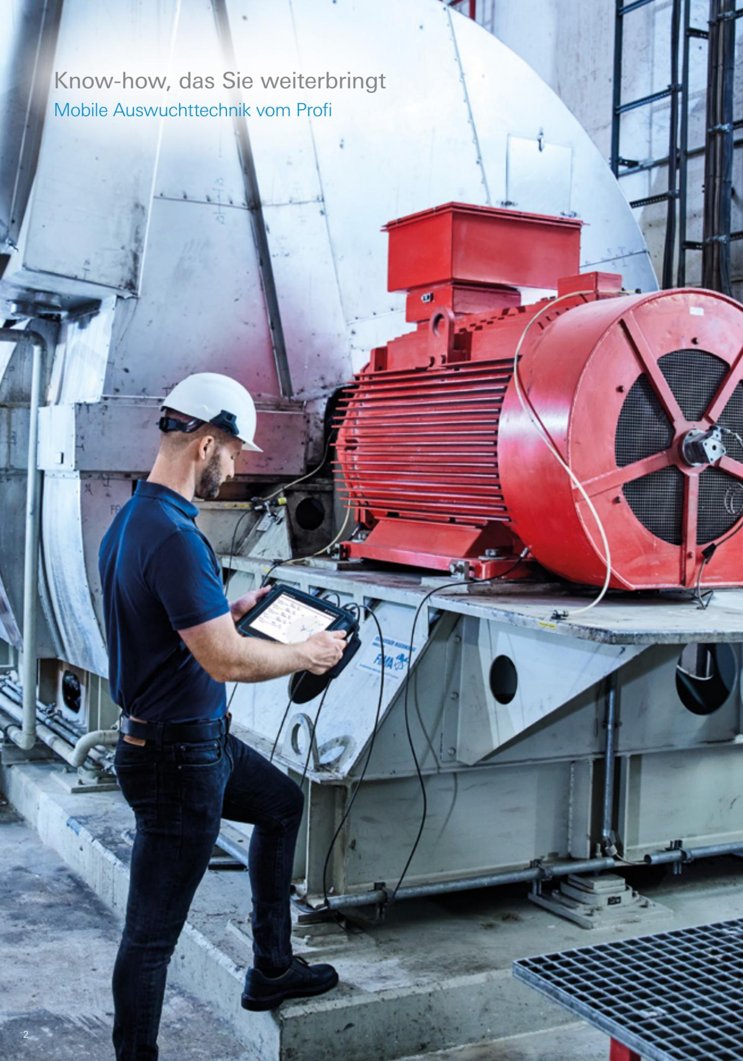
Studien belegen: Über 50 % der Fehler und Ausfälle an Maschinen und Anlagen lassen sich direkt oder indirekt auf Unwuchten an Rotoren zurückführen. Der innovative Smart Balancing-Modus des neuen SmartBalancer 4 hilft Ihnen, diese mühelos zu erkennen und zu beheben.
